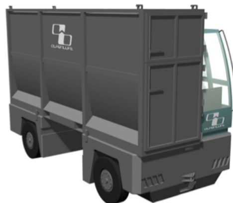
Sperrgutmulde 10 m 3 auf Fahrzeug
