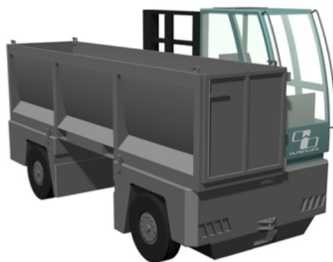
Bauschuttmulde 5 m 3 auf Fahrzeug
