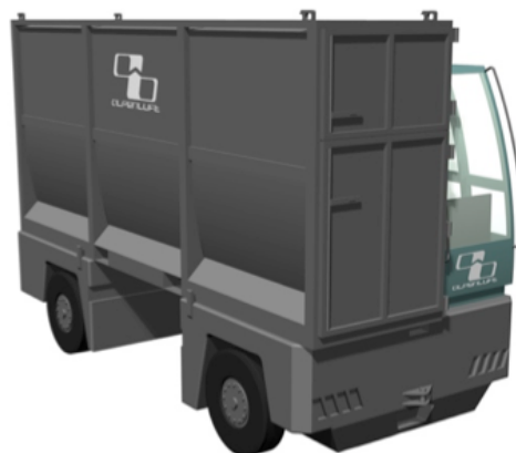
Benne à déchets encombrants de 10 m 3 sur un véhicule
